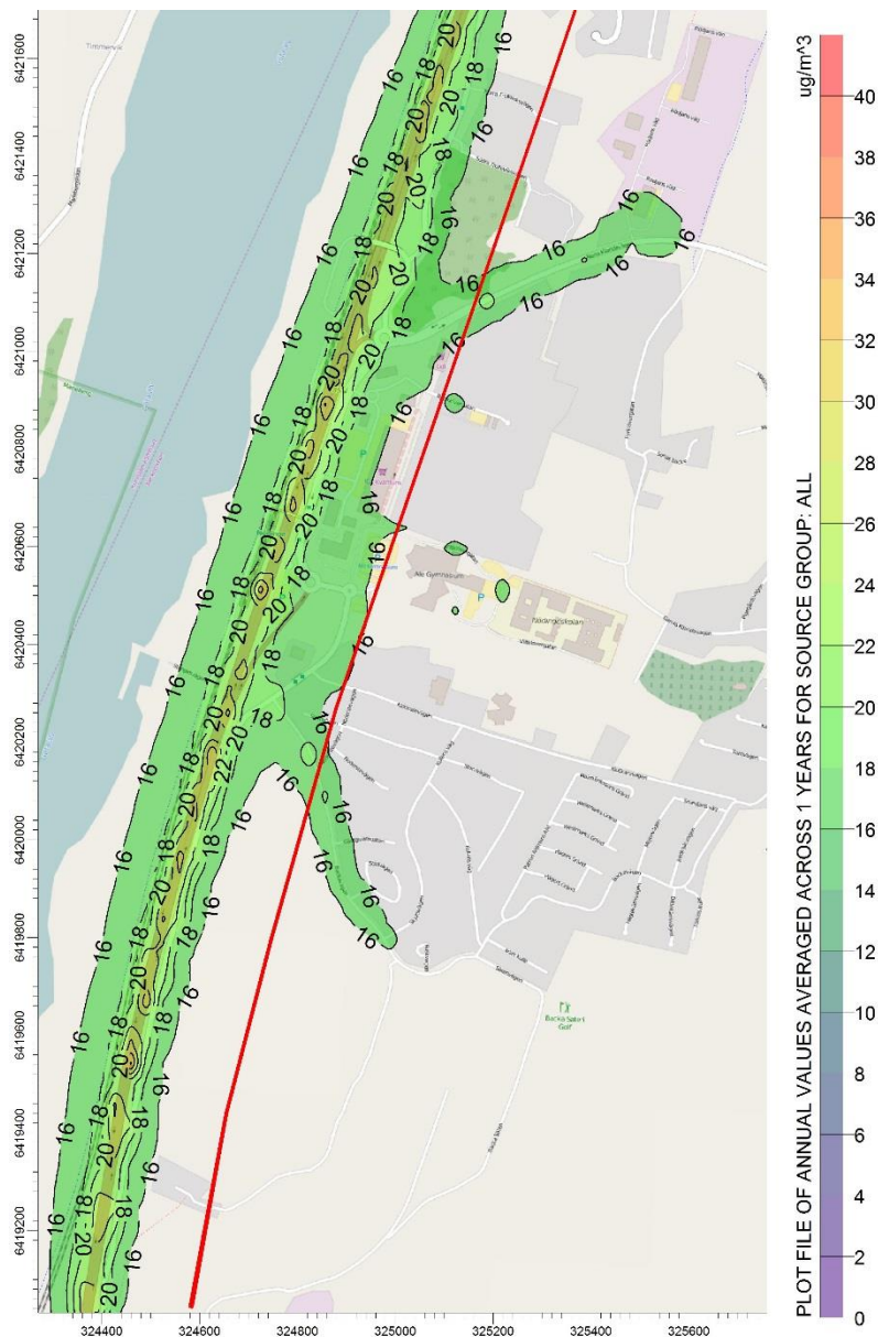
Figur 9. Framtida scenario 2030, beräknade halter av partiklar ( PM_{10} ) som årsmedelvärden. 200 meter från E45 är markerad med röd linje.
