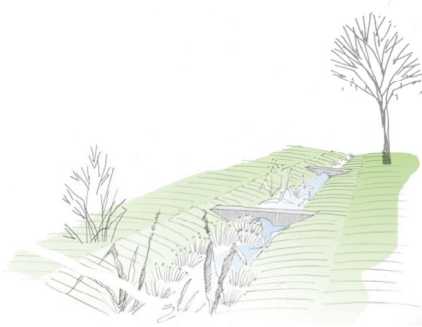
Bild 4. Exempel på öppen dagvattenhantering i bäcksystem med fall.
