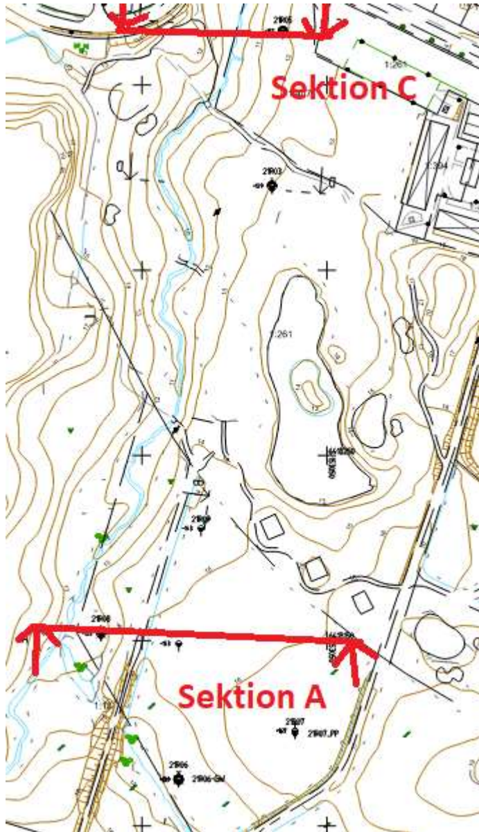
Figur 4, Sektioner för stabilitetsberäkningar.
