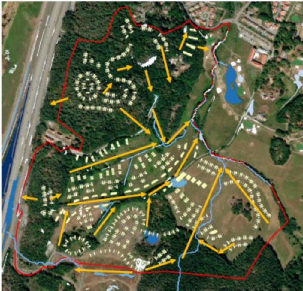
Figur 48. Föreslagen skyfallshantering, avledning via lutande hårdgjord yta eller öppna diken (orangea pilar illustrerar hur vattnet företrädevis leds).
