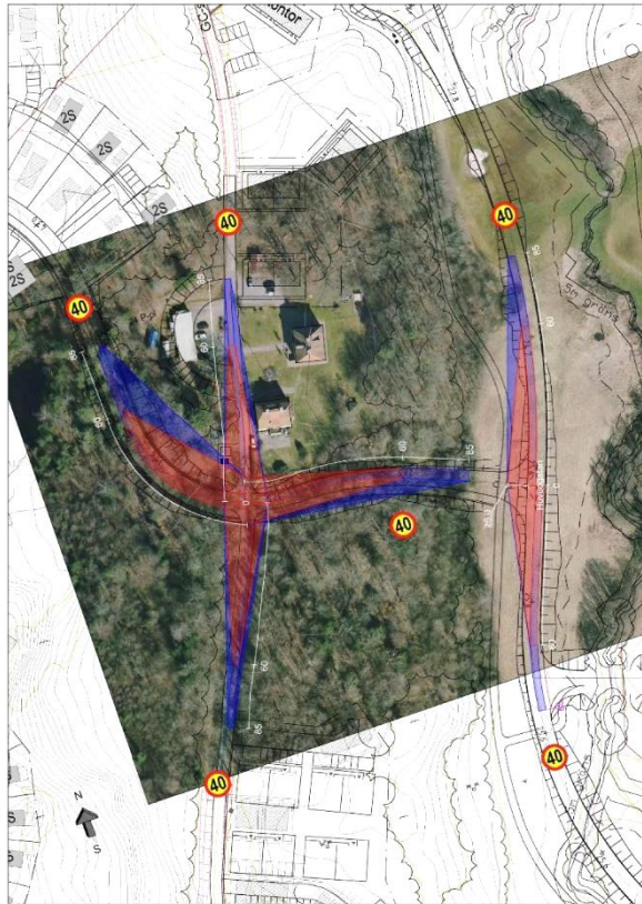
Figur 31. Siktanalys – Bruksvägen och Lahallsåsen
