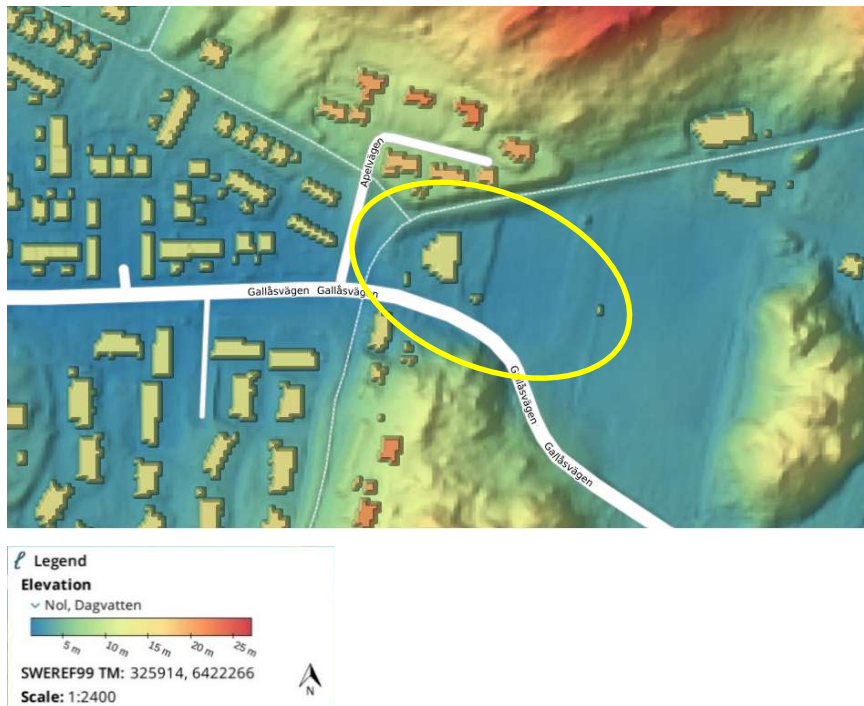
Figur 6. Figuren visar höjddata i en Scalgoanalys. Analysen är gjord på höjddata med 1 x 1 m upplösning. Gul markering visar ungefär utbredning av utredningsområdet. Kartbilden är gjord i Scalgo live.
