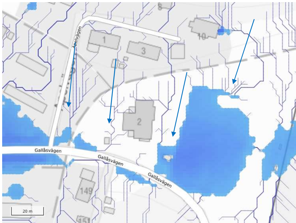
Figur 8. Figuren visar rinnvägar och instängda områden i utredningsområdet. De instängda områdena är illustrerade med ett 20 mm regn i Scalgo live. Pilarna illustrerar rinnvägsriktningen. Kartbilden är gjord i Scalgo live.
