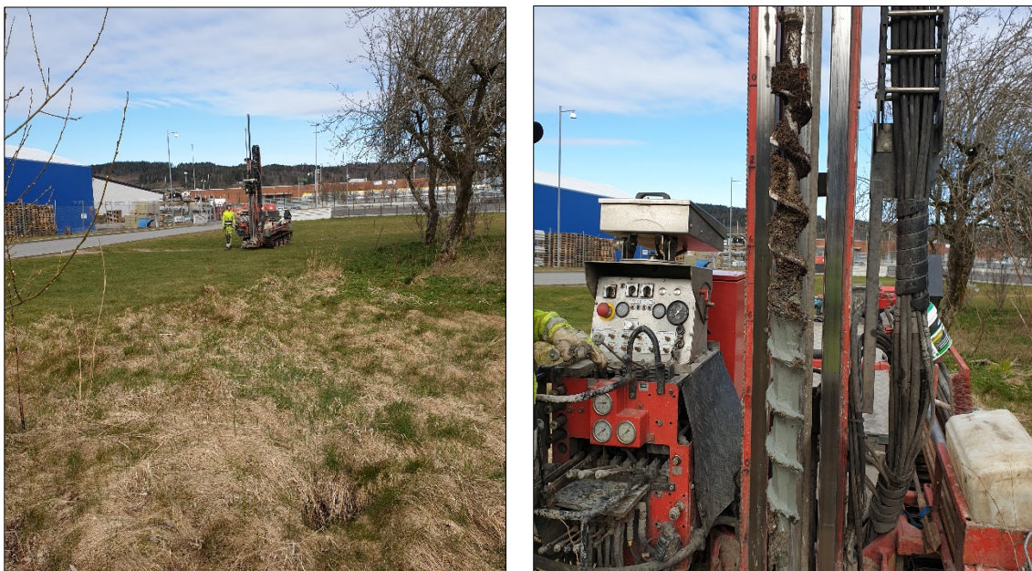
Figur 8. Till vänster är fotot taget mot grönytan. Till höger syns ytan vid Skr 2003 där man ser fyllnadsmaterial innehållande tegel under ovanliggande mulljord.
