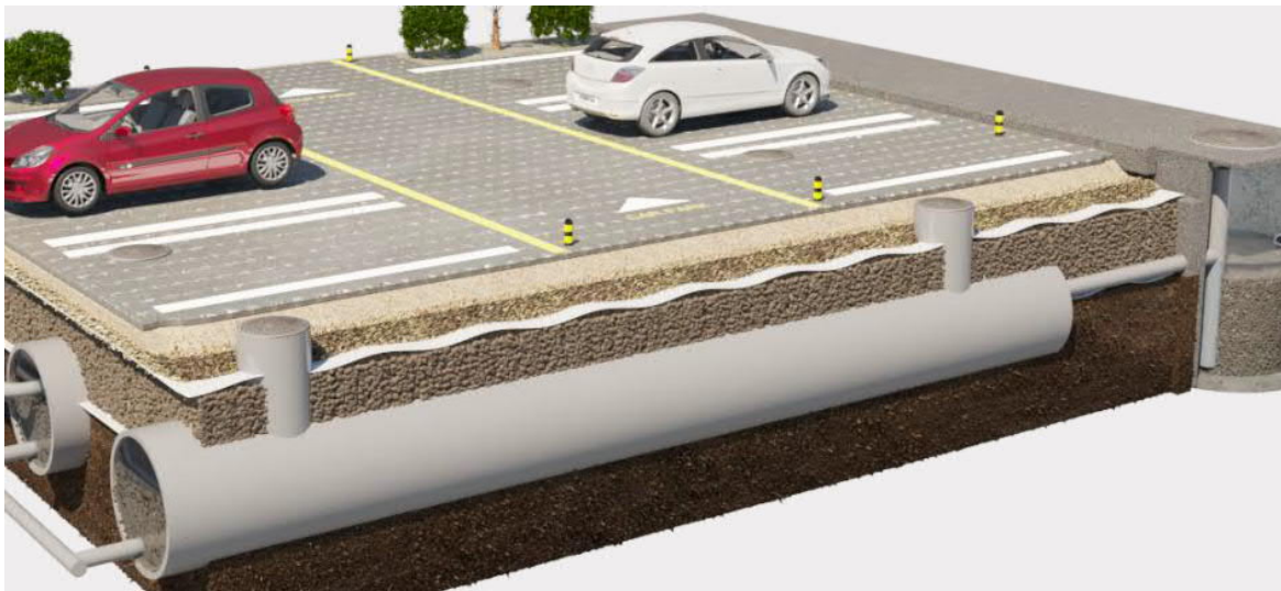
Figur 22. Exempel på fördröjning och rening i granulatfyllda rörmagasin. Bildkälla: Weric AB
