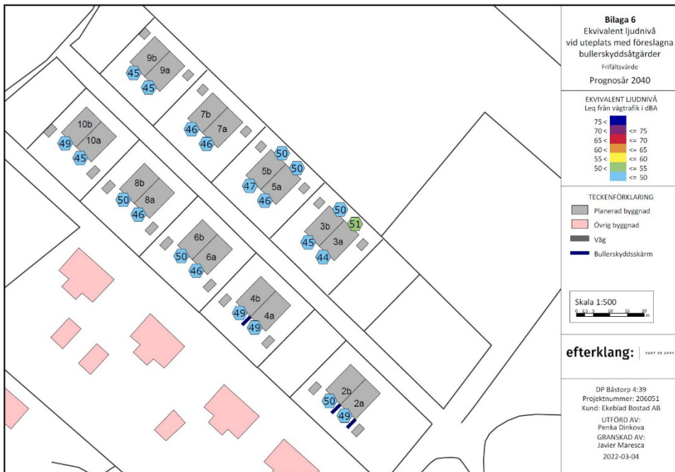
Bilaga 6 i bullerutredningen (Efterklang, 2022-03-04) som visar bullerskärmar vid uteplatser benämnda 2a, 2b och 4b.
