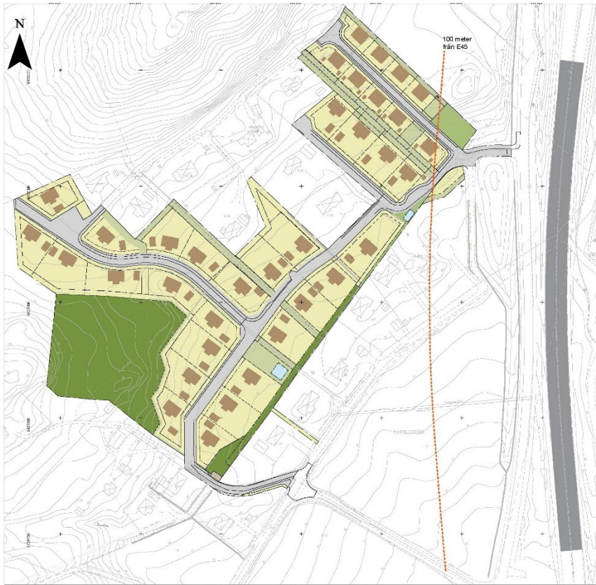
Planområdet i förhållande till väg 45. Röda streckade linjen redovisar 100-meters avstånd från vägen.
