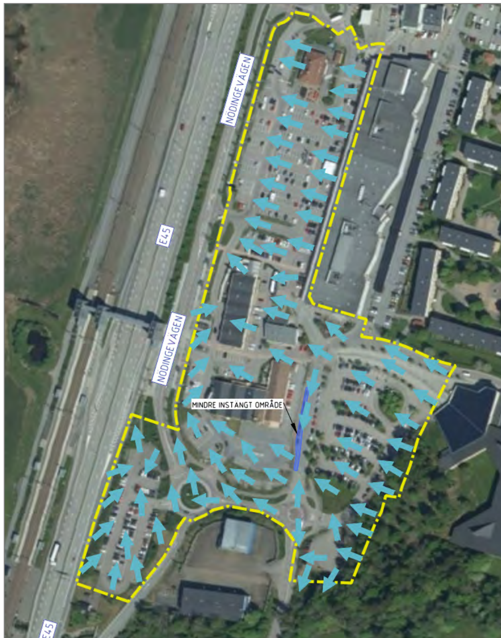
Figur 3. Skiss av ytavrinning inom planområdet som i stort sett sker från öst till väst.
