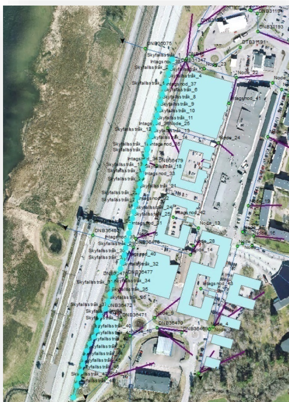
Figur 11. Översiktskarta – föreslaget yttligt skyfallsstråk utmed Nödingevägen. Modellberäknat med en nedsänkt öppen betongränna (bredd 1 meter samt 1 promilles lutning) med avledning till Hållsdammsbäcken.
