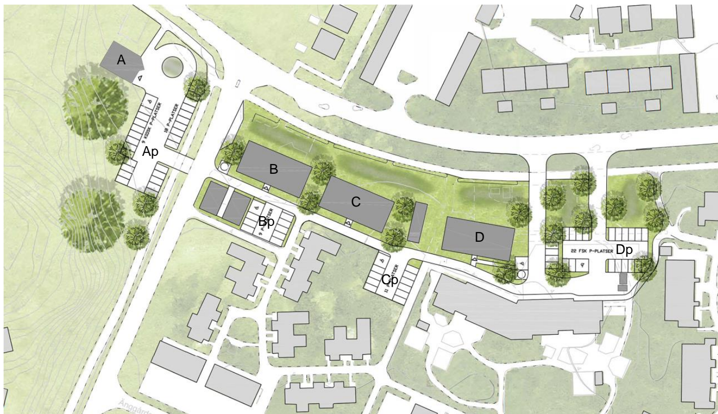
Figur 6. Ny illustrationsritning (mars 2022) där huskroppar och parkeringar flyttats upp från lågpunkten längs med Gallåsvägen och skuggade områden tas i anspråk för skyfallshantering. Bildkälla: Tyréns 2022.
