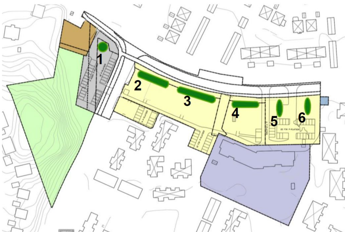
Placering av föreslagen skyfallsbaktering för att inte förrärra skyfallssituationen vid Gallåsvägen (WSP)
