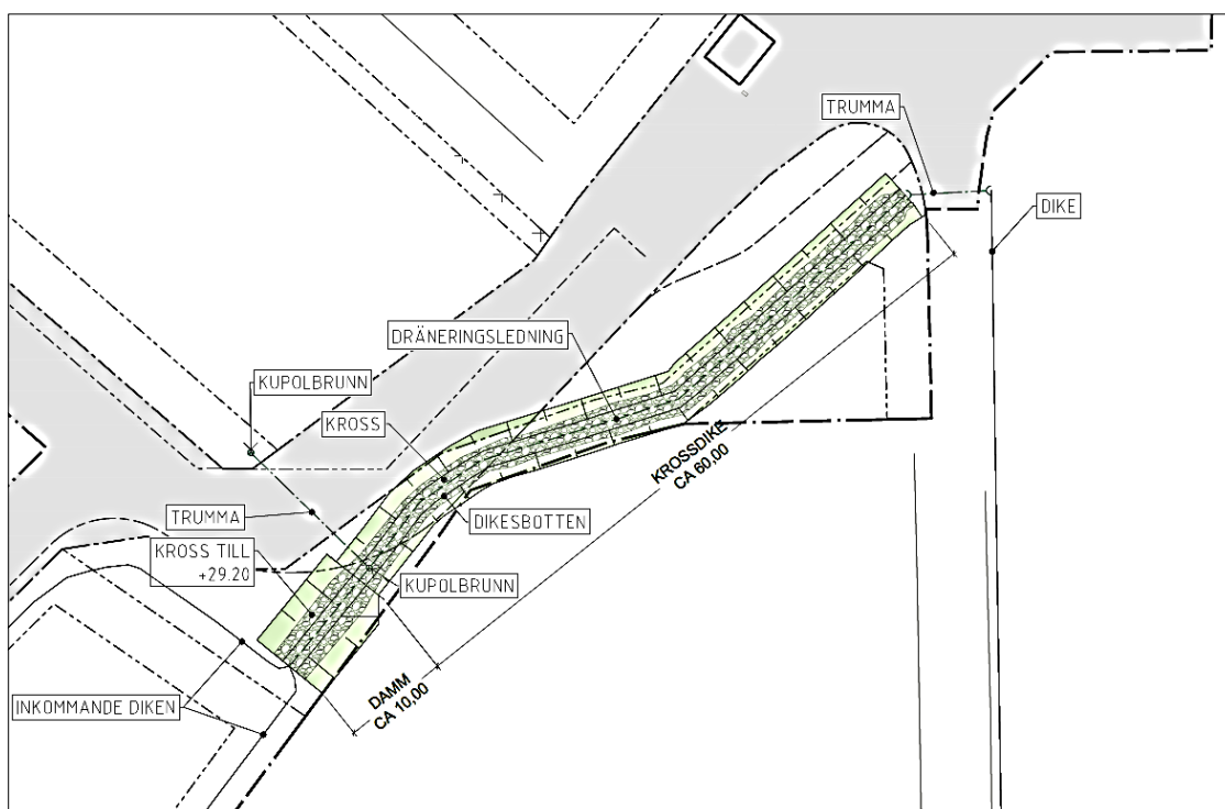
Figur 17 Förslag på utformning av torrdamm 2 område A1 ca 40 m 2 , 0,35 cm kross med ett medelvattendjup på 0,2 m ovan kross vid dimensionerande regn.
