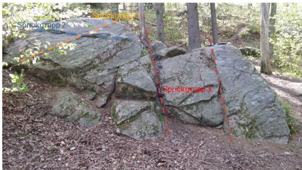
Figur 9.1. Område inom fastighet 5:40, där de olika sprickgrupperna är markerade.
