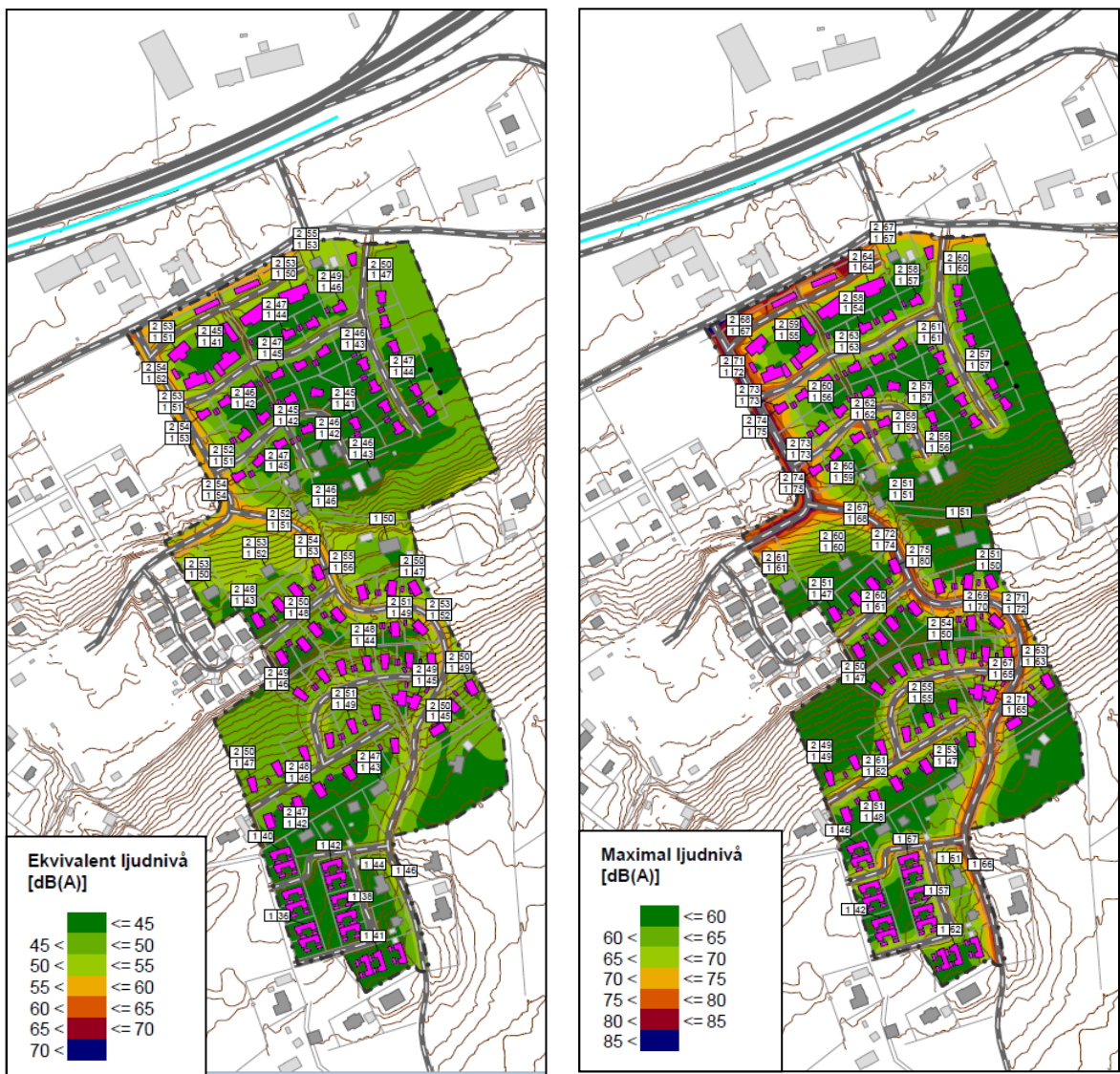
Ekvivalenta respektive maximala ljudnivåerna med Paradisområdet utbyggt år 2025, med ljudutbredning 1,7 meter över mark samt frifältsvärden per våningsplan.
